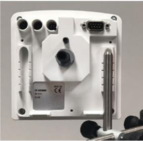
2. Montieren Sie die Haltestange am Verdampfer und befestigen Sie den Controller am oberen Teil der Haltestange, so dass die Haltestange fest in der Aussparung an der Controller-Rückseite einrastet.
